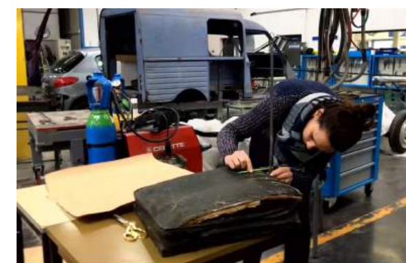
Relevé de mesures pour le gabarit sur l'assise du siège conducteur
