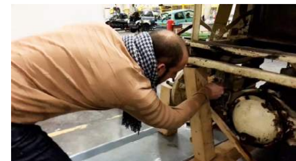
Mesure de la sangle de cuir bridant le débattement du pont arrière de Scarabée d'Or
