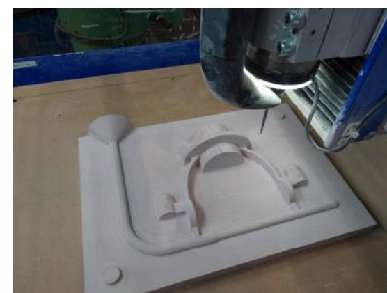
Réalisation du moule servant à la fabrication du porte compas
