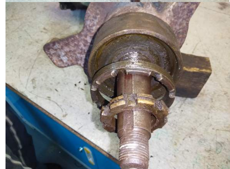
Un des sorties du pont arrière qui s’emboîte dans l’axe de la poulie motrice arrière de la chenille
