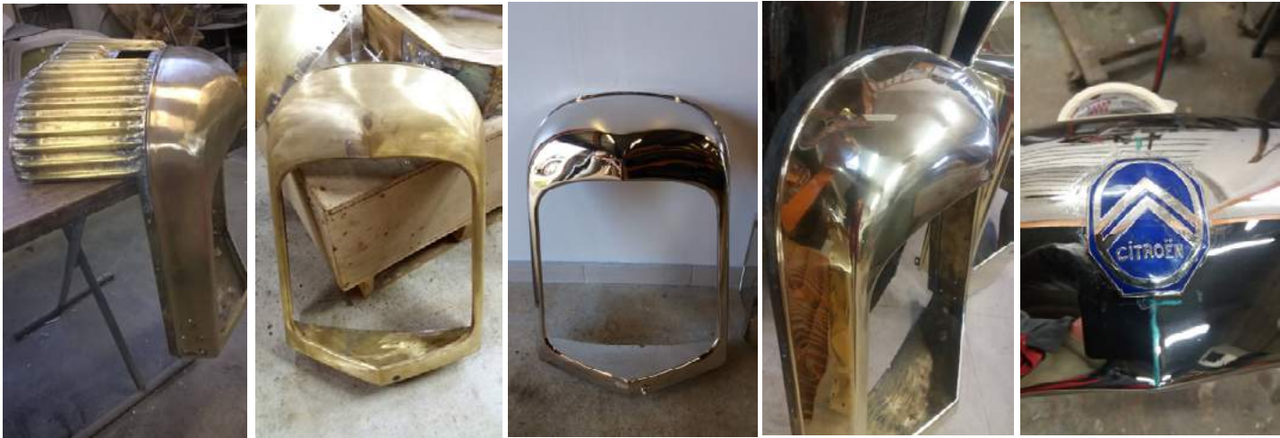
Elles sont ensuite réassemblées sur la structure. La calandre est nettoyée avant nickelage.
