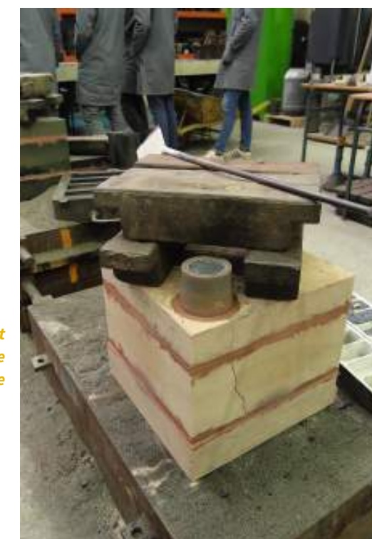
Le moule refroidit lentement avant ouverture pour laisser apparaître la pièce brute de fonderie
