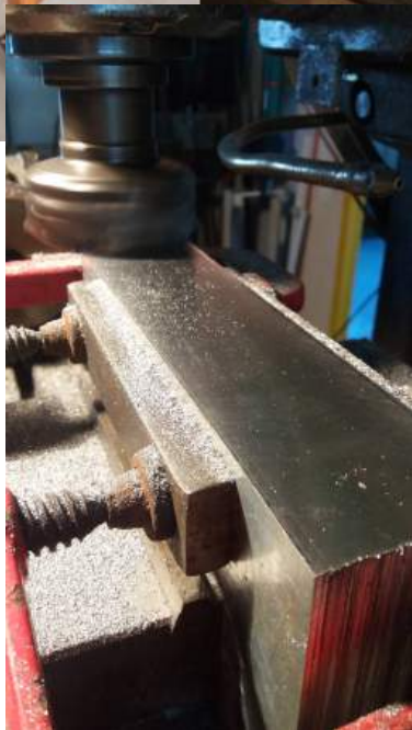
Usinage des futures ailettes
