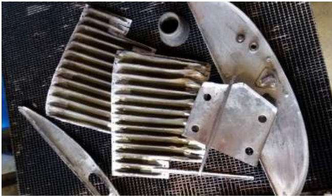
Après démontage, les ailettes sont nettoyées, puis redressées
