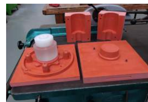
Fabrication du moule d'une pièce de la poulie motrice de la chenille (Campus d'Angers)
