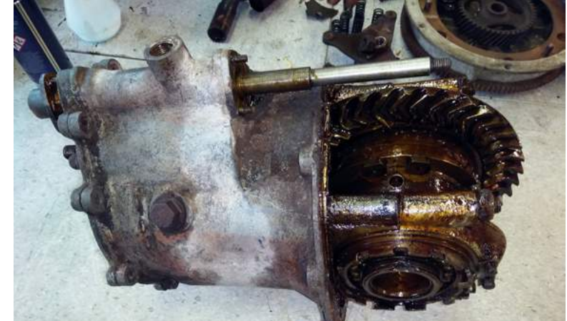
Le carter du pont arrière est en fonte d’aluminium et comporte ici le différentiel
