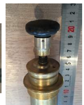
Pompe à air avec son mécanisme déployé Une fois repoussé, le bouton poussoir se visse sur le corps de la pompe
