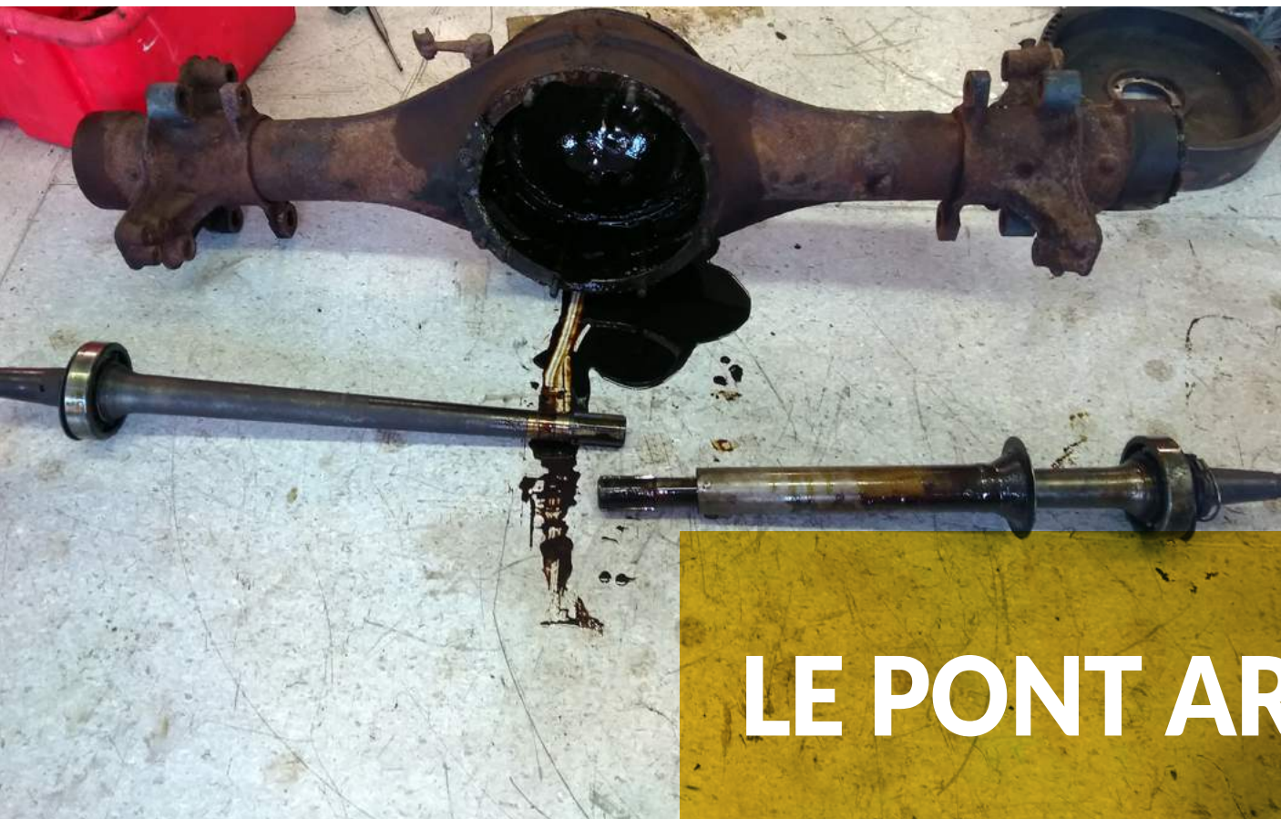
Le pont arrière démonté avec les deux arbres encore appelés “tulipes”
