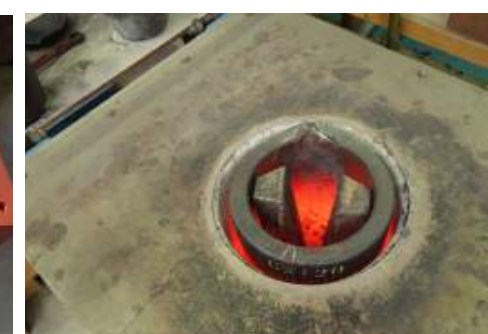
Les pains de bronze chauffent dans le four électrique
