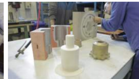
Observez à droite de la photo la pièce de bronze obtenue après la coulée
