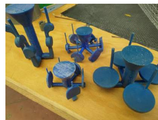
Modèles de pièces d'accastillage en cire avant fonderie (verrous de fermeture des abattants du caisson arrière)
